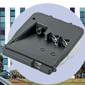
トヨタが採用したコンチネンタルの衝突回避支援システムのモジュール（円内）と搭載車
